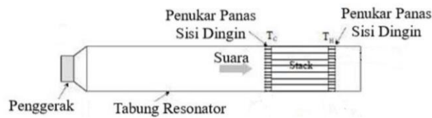
Gambar 1. Ilustrasi komponen mesin pendingin termoakustik
