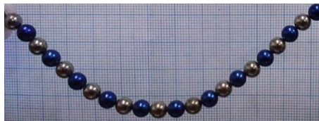
Gambar 7. Rantai butiran magnetik dicampur dengan butiran besi (contoh material komposit).
