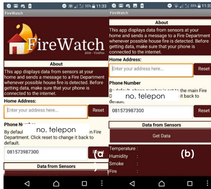
Gambar 11. Tampilan aplikasi “FireWatch” menunjukkan deskripsi aplikasi (a), textbox untuk mengisi alamat rumah dan nomor telepon (a, b), tombol untuk menginisiasi pengambilan data (b), dan tampilan data (b)
