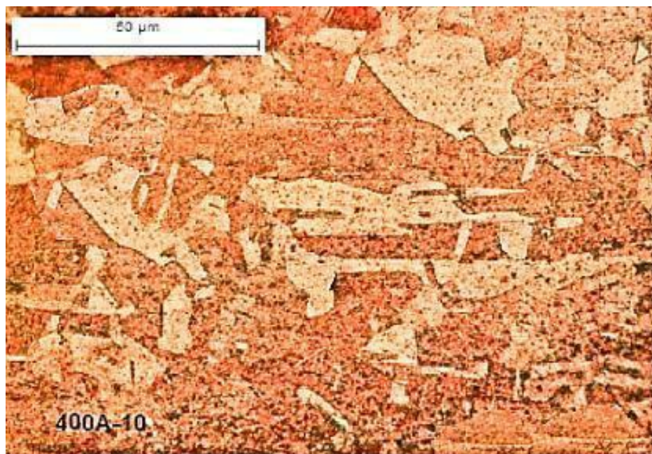
Gambar 3.4 Struktur mikro hasil annealing pada 400°C dengan holding time 10 menit
