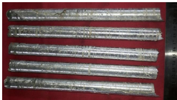
Gambar 2.3. Bakalan hasil proses pengecoran ( as-cast ) berukuran \varnothing 20 \times 200 mm.
