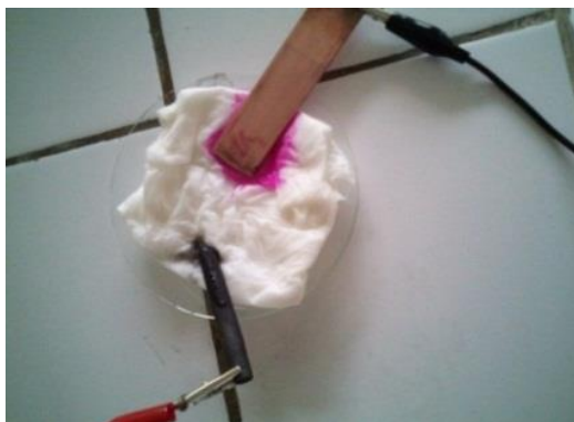
Gambar 8. Elektrolisis campuran NaCl dan HCl menggunakan constant current power supply AR.500 setelah dialirkan arus
