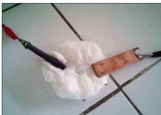
Gambar 7. Elektrolisis campuran NaCl dan HCl menggunakan constant current power supply AR.500 sebelum dialirkan arus
