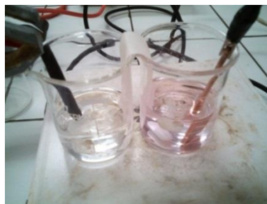
Gambar 6. hasil elektrolisis campuran NaCl dan HCl menggunakan constant current power supply bio rad
