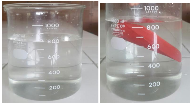
Gambar 9. Percobaan mengukur volume irisan kerucut dengan prinsip Archimedes
