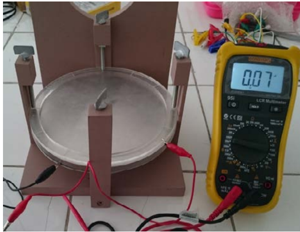
Gambar 3. Percobaan menentukan konstanta dielektrik akrilik [5]
