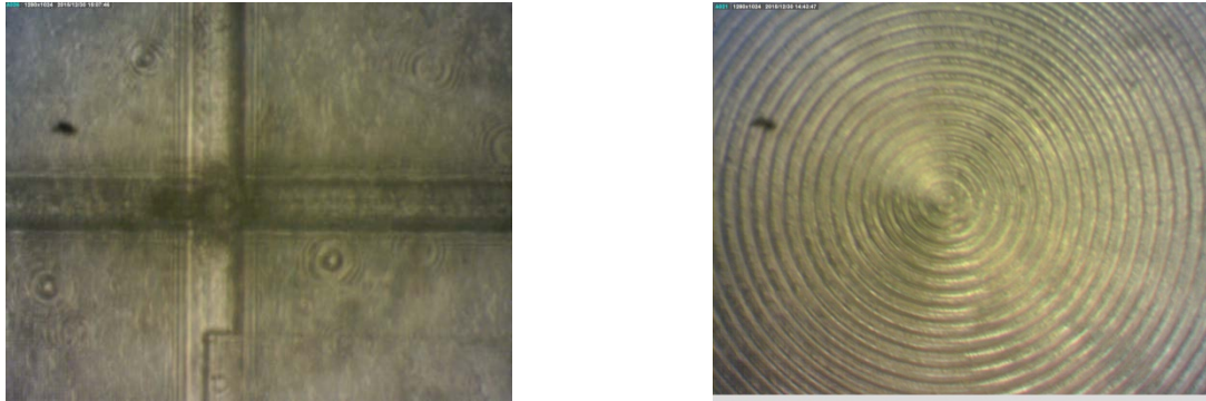
Gambar 4. Hasil eksperimen pola mikrokanal dengan perbesaran lima kali
